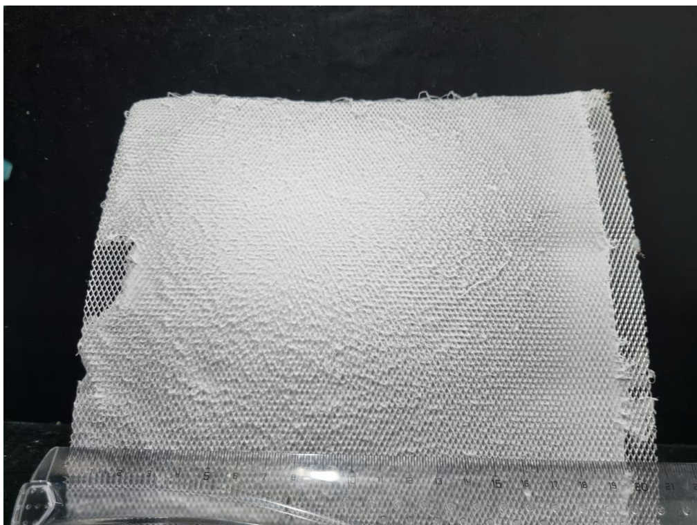
Figura 10. Fiação de PCL/PEG 8 utilizando coletor de malha de alumínio expandida.
